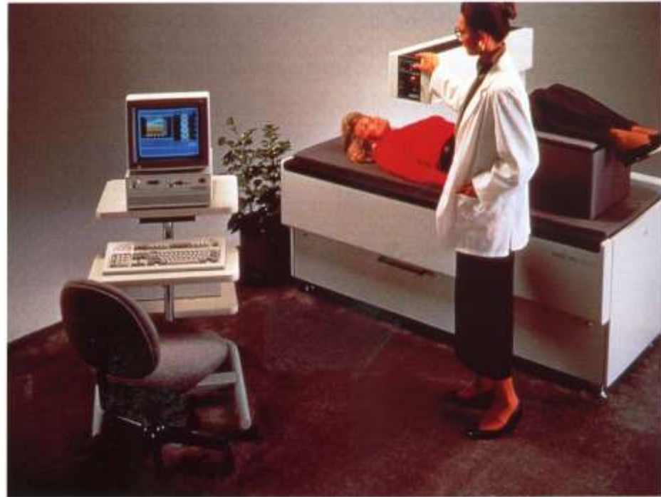
Şekil 5.9 Dual-enerji X-ışın absorpsiyometri cihazı (DEXA; Lunar DPX-IQ). Lunar, Madison, WI'nin izniyle.
